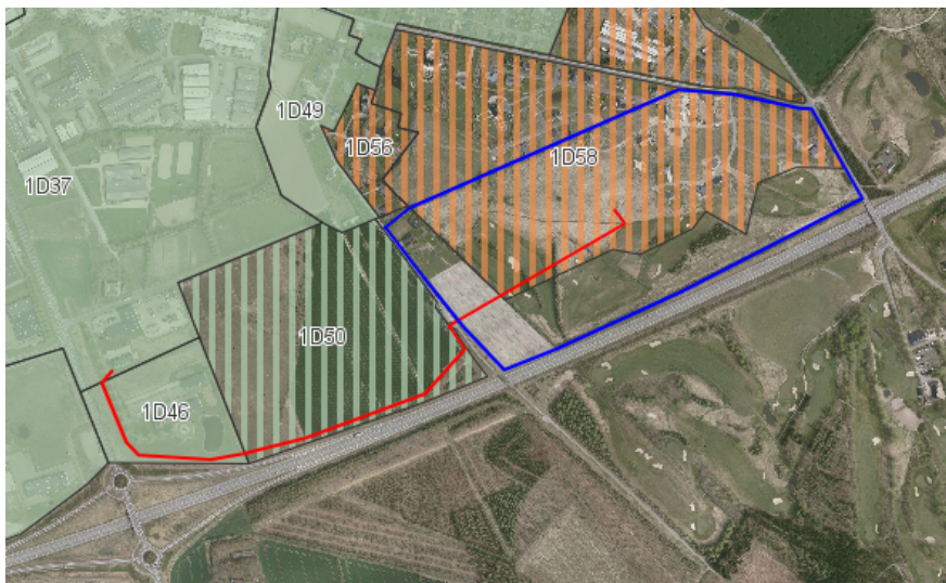
Figur 1: Kloakoplade og kloakeringsprincipper. Afgrænsningen med blå viser det kommende lokalplanområde. Rød linje viser det nævnte ledningstracé.
